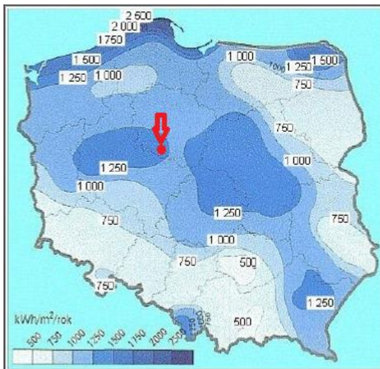
Rysunek 4. Położenie miasta i gminy Piotrków Kujawski na mapie energii wiatru w kWh/m 2 na wysokości 30 m nad poziomem gruntu
